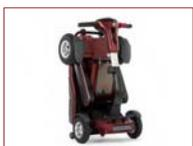
Sistema di ripiegamento automatico motorizzato
